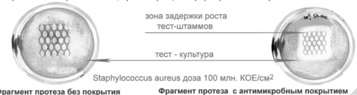
Фрагмент протеза без покрытия Фрагмент протеза с антимикробным покрытием
